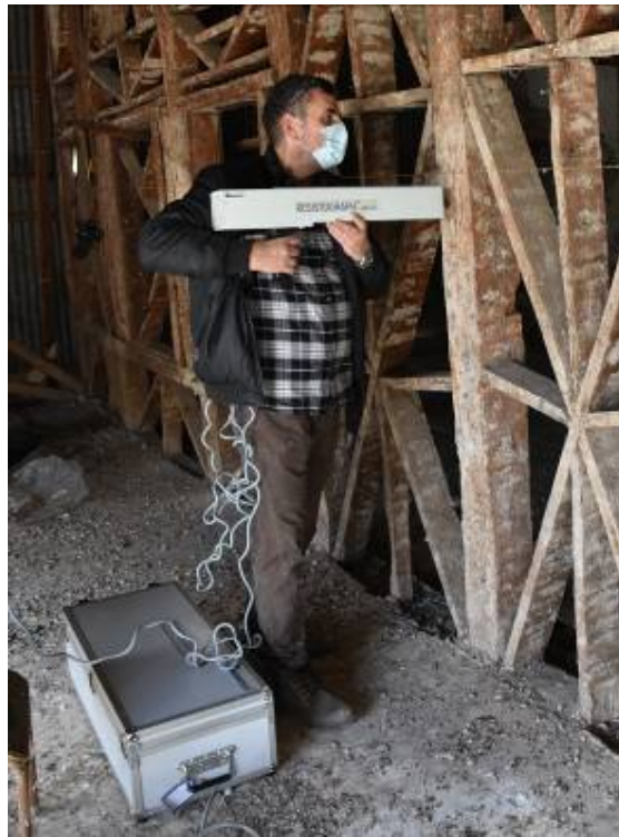
Φωτ. 151 Μέτρηση της πυκνότητας του ξύλου σε ύψος 1,40μ. από το δάπεδο (μπροστινή πλευρά, πάχους 17εκ.).
