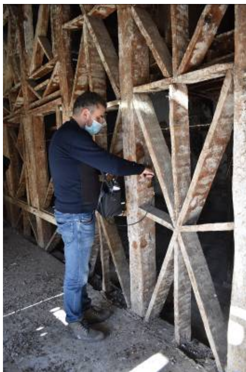
Φωτ. 148 Μέτρηση της αποσυνθεμένης μάζας των ξύλινων στοιχείων με συσκευή υπερήχων.
