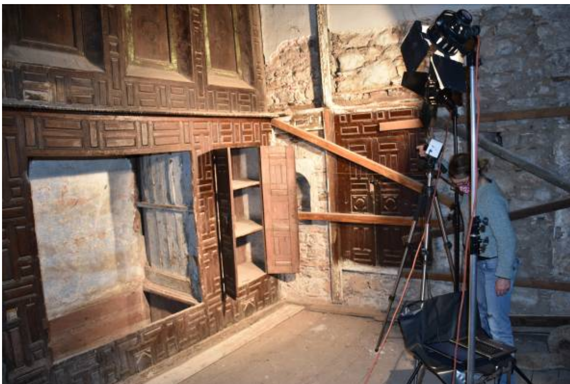
Φωτ. 156 Παρατήρηση και φωτογράφιση με το σύστημα Musis και αποθήκευση των δεδομένων σε φορητό ηλεκτρονικό υπολογιστή.
