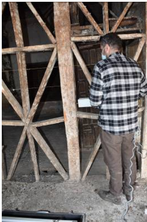
Φωτ. 153 Μέτρηση της πυκνότητας του ξύλου σε ύψος 1,10μ. από το δάπεδο (πλαϊνή πλευρά, πάχους 15εκ.).
