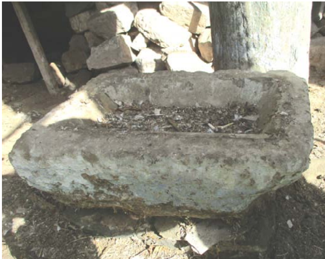
Φωτ. 446-449. Στα λίθινα στοιχεία που έχουν επαναχρησιμοποιηθεί, όπως εδώ στον μαρμάρινο νυπτήρα, παρατηρείται εξαλλοίωση του λίθινου υλικού, με αποτέλεσμα την απώλεια υλικού επιφανείας, την αλλαγή του σχήματος, αλλά και των διαστάσεων των λίθων.
