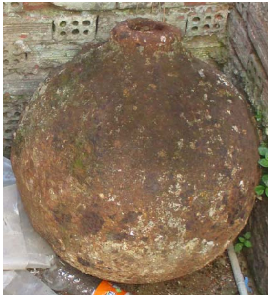
Φωτ. 401-402. Η μεταλλική μπάλα παρουσιάζει παχύ στρώμα προϊόντων διάβρωσης του σιδήρου σε συνδυασμό με προσροφημένα χρώματα, άλατα και ρύπους και ενδείξεις ενεργού διάβρωσης με αποφλοιώσεις και ρηγματώσεις των στρωμάτων διάβρωσης. Εμφανίζει επίσης και πράσινο στρώμα βιολογικών επικαθίσεων.
