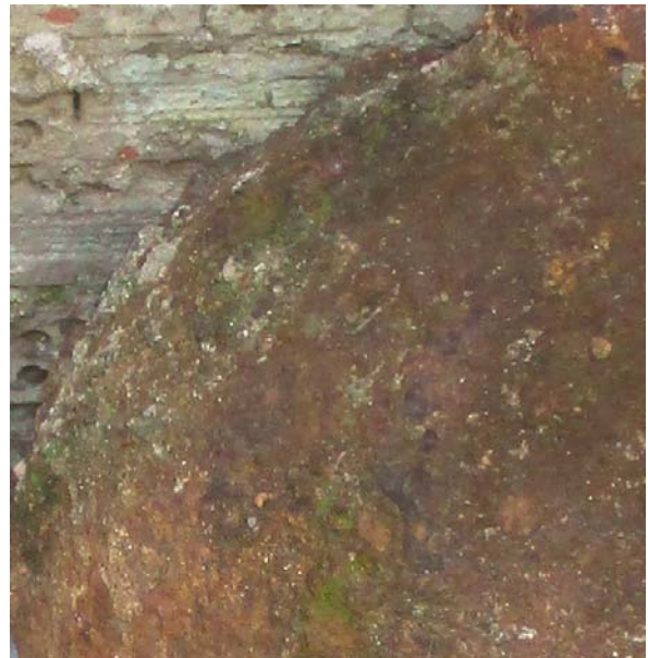
Φωτ. 401-402. Η μεταλλική μπάλα παρουσιάζει παχύ στρώμα προϊόντων διάβρωσης του σιδήρου σε συνδυασμό με προσροφημένα χρώματα, άλατα και ρύπους και ενδείξεις ενεργού διάβρωσης με αποφλοιώσεις και ρηγματώσεις των στρωμάτων διάβρωσης. Εμφανίζει επίσης και πράσινο στρώμα βιολογικών επικαθίσεων.
