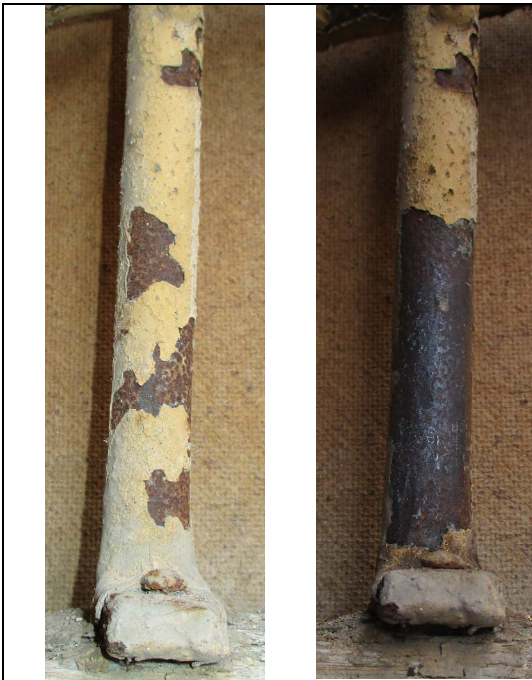
Μηχανικός καθαρισμός εν ξηρώ με αποξεστικό χαρτί διαφορετικής κοκκομετρίας
