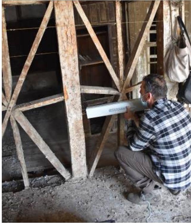
Φωτ. 155 Μέτρηση της πυκνότητας του ξύλου σε ύψος 0,70μ. από το δάπεδο (πλαϊνή πλευρά, πάχους 15εκ.).
