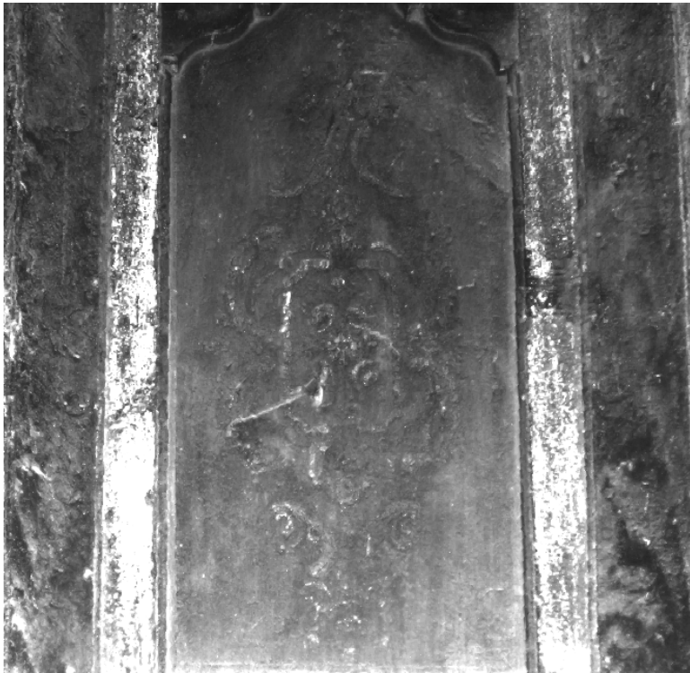
Φωτ. 165 Φωτογράφιση με το σύστημα Mysis στα 600nm (ορατό φάσμα). Οι ρύποι και το βερνικόχρωμα καλύπτουν λεπτομέρειες της ζωγραφικής του πέμπτου άνω ταμπλά της μουσάντρας του ανατολικού οντά
