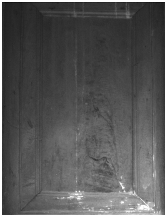
Φωτ. 168 Φωτογράφιση με το σύστημα Muisis στα 1000nm (IR,υπέρυθρο), όπου δεν διακρίνεται υποκείμενο ζωγραφικό στρώμα στον πρώτο άνω ταμπλά της μουσάντρας του δυτικού οντά.
