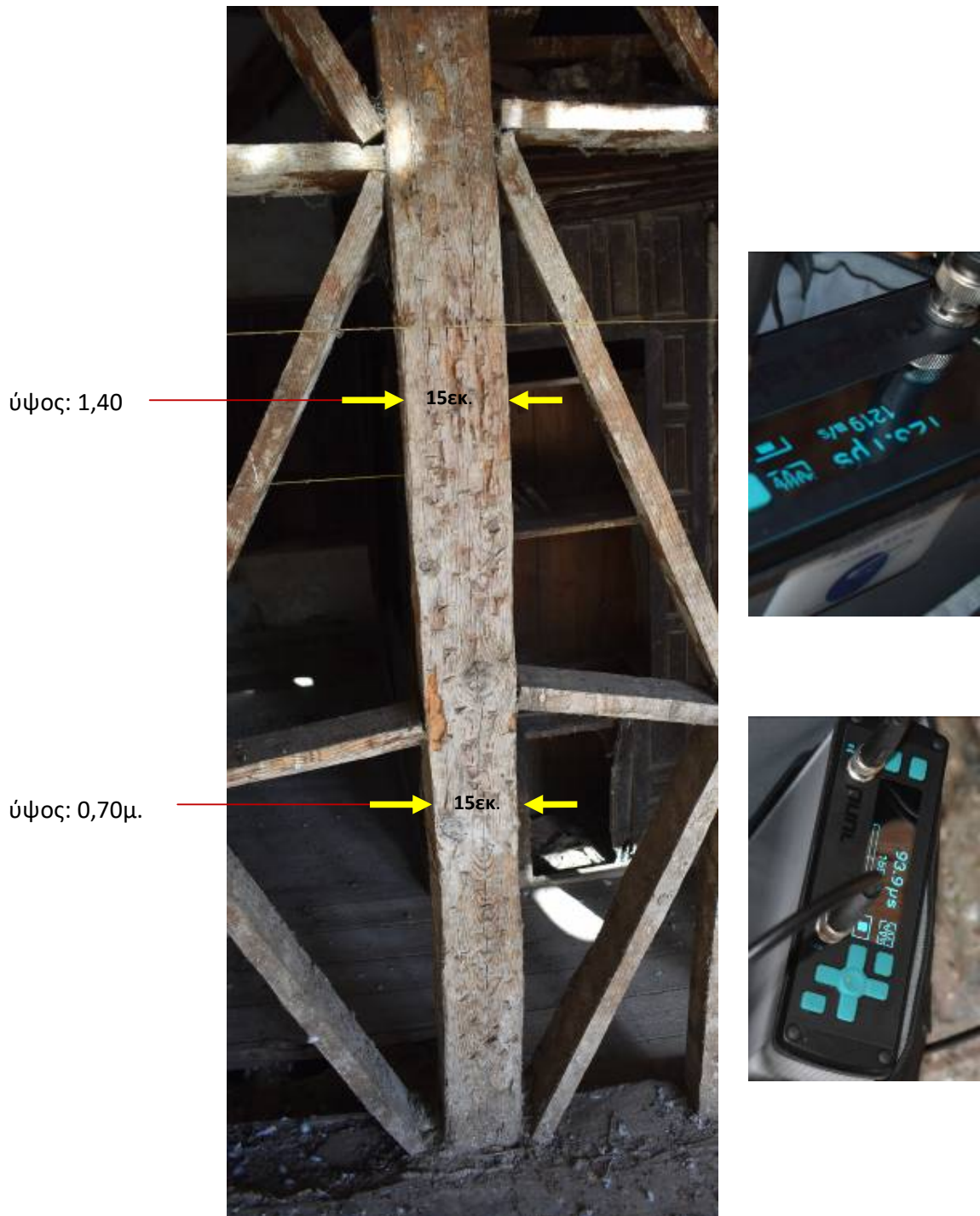
Φωτ. 149 Μέτρηση της αποσυνθεμένης μάζας του ξύλινου υποστυλώματος, σε ύψος 0,70μ. και 1,40μ. από το δάπεδο και σε direct κατεύθυνση 15εκ.
